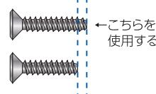
コンベックスのベルトクリップ部のネジ
