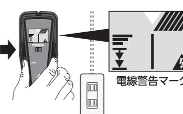
\*壁材の乾燥具合、壁材から電線の間に障害物の有無によって数値は変動します。
