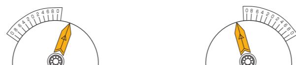
図Aでは指針が右側にあります。したがって向かって左側のバーニヤ目盛を使用し、0から最初に合う目盛を探します。図Aではバーニヤ目盛の4が外側目盛と合っていますので、小数点以下の数値は0.4になります。これを(3)で荒読みした26といたします。
