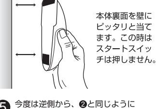
② 壁に当ててから左横にあるスタートスイッチを押し、液晶画面右上にスタートが表示されると探知可能です。そのまま壁から離さずに右方向へスライドさせます。
