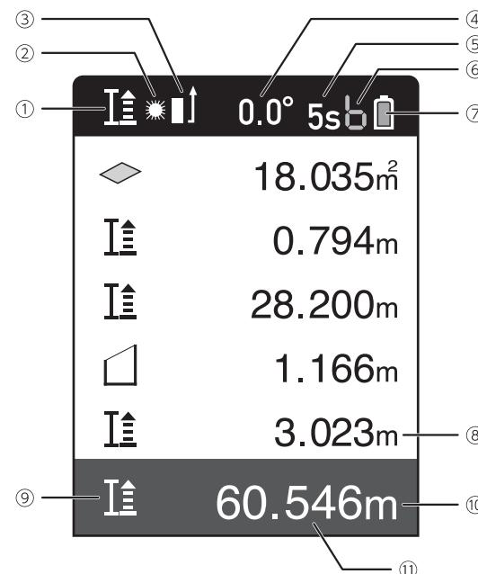
①現在の測定機能表示 ②レーザー光照射表示 ③測定基準表示 ④角度表示
