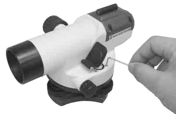
図10 円型気泡管調整ネジによる気泡の調整
