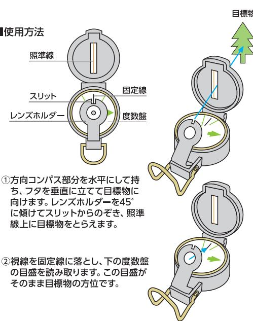
①方向コンパス部分を水平にして持ち、フタを垂直に立てて目標物に向けます。レンズホルダーを45°に傾けてスリットからのぞき、照準線上に目標物をとらえます。
