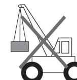
②クレーン車など、大型機械から10m以内、および自動車から3m以内。
