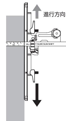
突き当てを刃の進行方向と逆に可動させることで材料の端面まで安定して切断できます。
