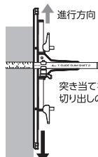
突き当てを刃の進行方向と逆に可動させることで材料の端面まで安定して切断できます。切り出しの場合は突き当てを進行方向に可動させることで安定した切り出しができます。
