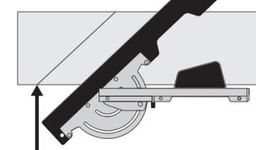
裏面なら材料の左端から電気丸ノコで切断ができる。
