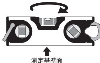
測定基準面にゴミなどの付着や打痕による突起がないことを確認してください。
