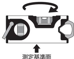
測定基準面にゴミなどの付着や打痕による突起がないことを確認してください。
