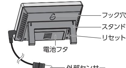
※本体裏面のリセットは、静電気などで誤作動を起こした際に針金のような物で押してください。電池を交換した際にもリセットされます。
