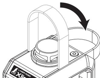
②円型気泡管の気泡が白い円内に入るように、水平調整脚で調整し、本体の水平出しを行ってください。
