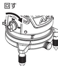
②電源スイッチを回してONにしてください。自動補正機構のロックが解除され、レーザーが照射されます。\*
