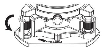
⑤水平調整三脚アダプターの回転フックを回転させ、インジケーターをLOCKの位置に合わせます。
