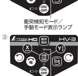
③本体を設置した位置から動いた場合、回転ヘッドの回転が止まりレーザーポイントが点滅します。
