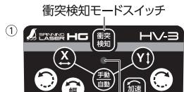
②解除する時は、衝突検知モードスイッチを再度押すと衝突検知モード／手動モード表示ランプ(青色LED)が消灯します。
