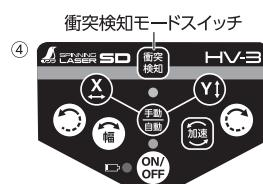
④復帰する時は、衝突検知モードスイッチを押します。衝突検知モードが解除され、復帰します。
