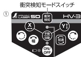
②解除する時は、衝突検知モードスイッチを再度押すと衝突検知モード／手動モード表示ランプ(青色LED)が消灯します。
