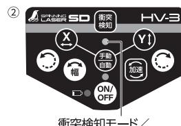
③本体を設置した位置から動いた場合、回転ヘッドの回転が止まりレーザーポイントが点滅します。
