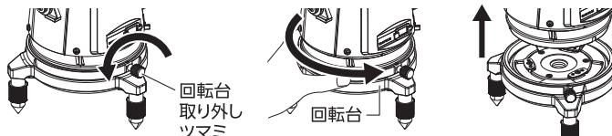
②回転台に自動追尾回転台を載せて時計回りにまわします。取り付ける際は下図を参考にしてください。
