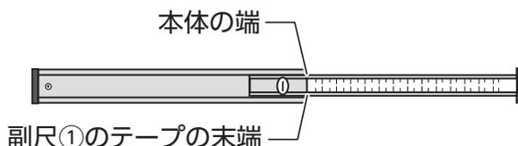
2. 黄色の止ネジ②を緩め、副尺②をスライドさせ止めた時の全体の寸法は矢印のところの目盛で読み取ります。
