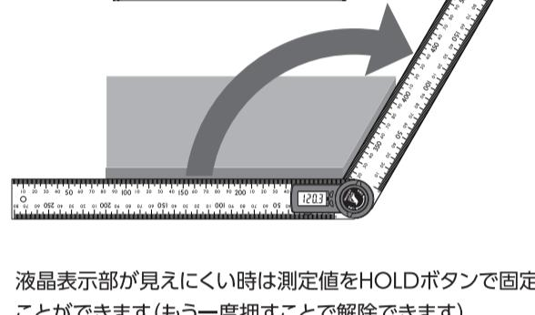
液晶表示部が見えにくい時は測定値をHOLDボタンで固定することができます(もう一度押すことで解除できます)。
