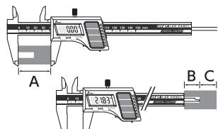
A)にノギスを合わせ、ZEROセットスイッチを押します。そのままBを測定する事により、Cの寸法が測定できます。(マイナスは無視してください)。
