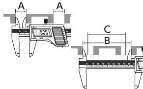
同一径の2ヶの穴の中心と中心の間の距離がわかります。A)にノギスを合わせ、ZEROセットスイッチを押します。そのままBを測定する事により、Cの寸法が測定できます。
