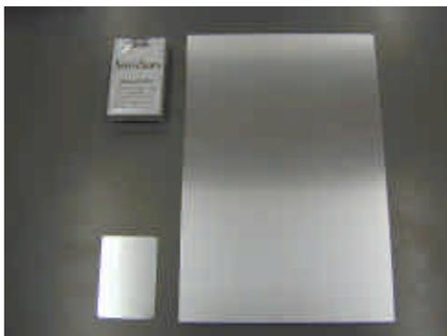
放熱板と同一の材料をヒーターサイズと同じ 7 8 × 5 4 mm サイズにカットする。
