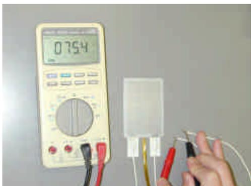
引き続きヒーター電線間の抵抗値をテストにて測定する。
