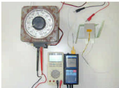
測定開始時のダミー放熱板温度を測定し(今回の場合20.4)、温度を見ながら0Vより徐々に電圧を上げて行きます。
