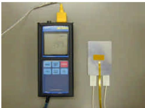
ダミー放熱板の中央部に温度計のセンサを耐熱テープで貼り付け、温度を測定する。
